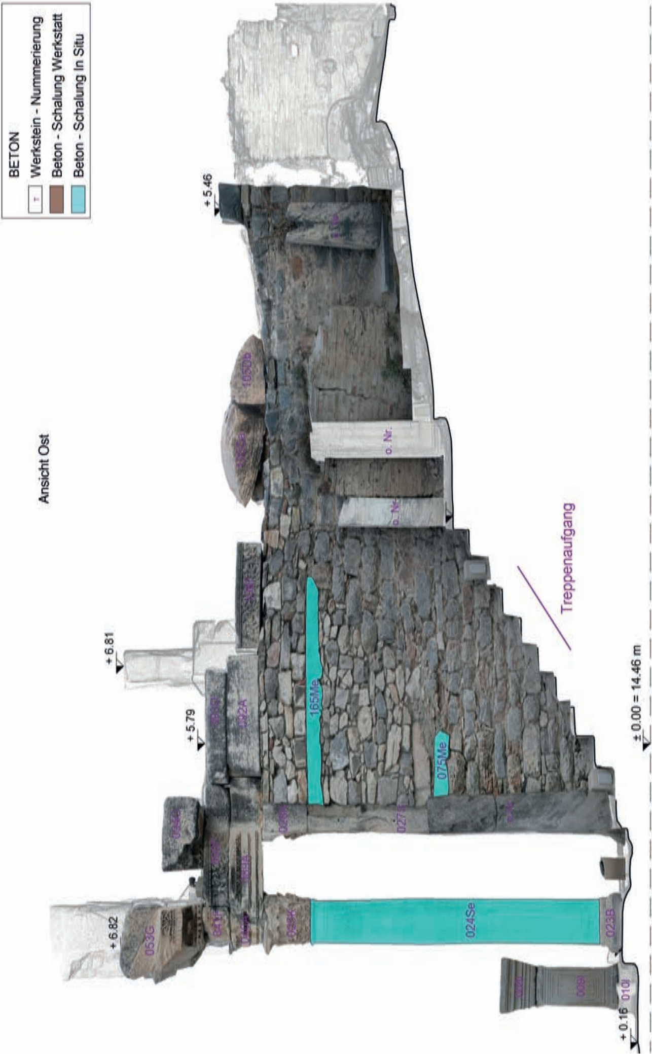
›Hadrianstempel‹, Verteilung des Betons. Ansicht Ost
